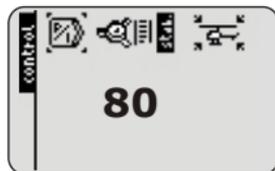
Falls der Heli auf der Rotorebene im Schwebeflug schnell zu schütteln beginnt, so reduzieren Sie diesen Wert. Wenn Sie hingegen den Eindruck haben, dass der Heli sehr unsauber fliegt und z.B. beim Pitchgeben nicht gerade wegsteigt oder im Schnellflug nicht die Flugbahn einhält, so erhöhen Sie die Stabilität.
